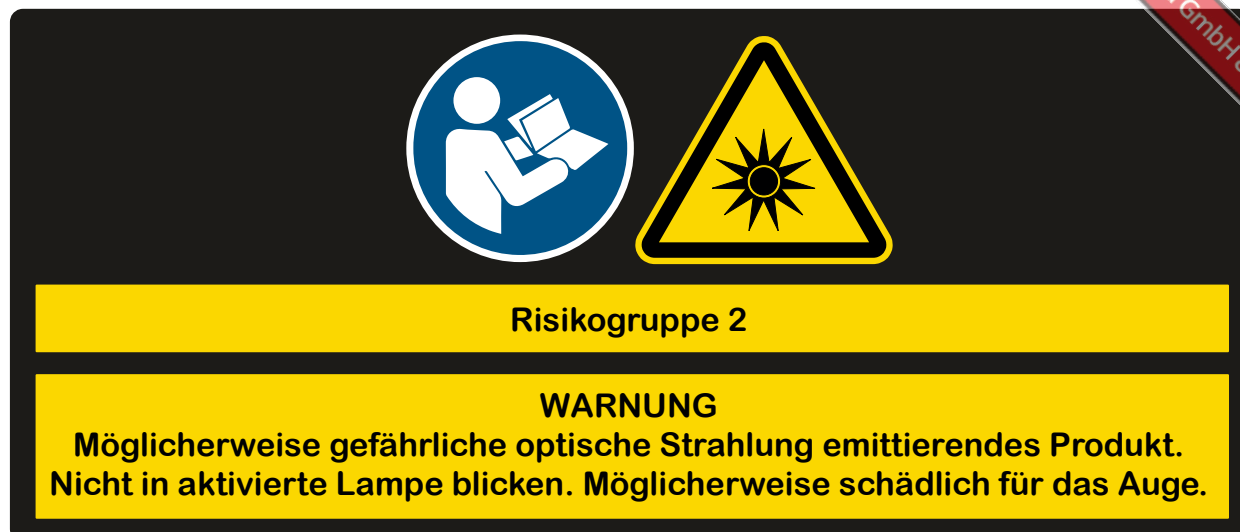
^ 03 Beispiel der Kennzeichnung eines Produktes mit optischer Strahlung der Risikoklasse 2 (Grafik: C. Prall, smart optics Sensortechnik GmbH)
