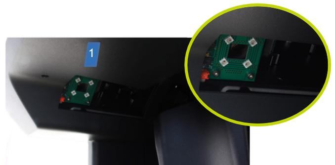
1. Éléments optiques (caméra et capteur)
