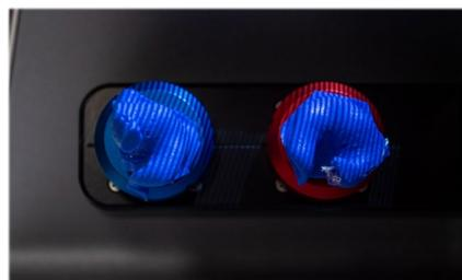
Ein Streifenmuster wird vom 3D-Sensor auf das zu scannende Objekt projiziert und von der Kamera aufgezeichnet.
