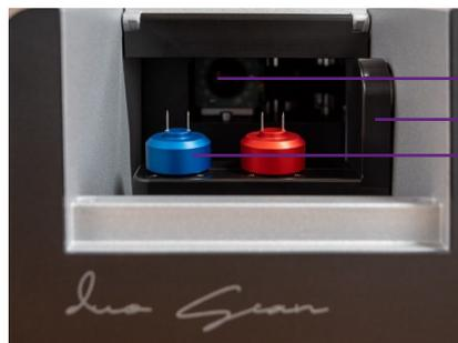
Le mécanisme de positionnement à l'intérieur du scanner se compose d'un axe pivotant entraîné par un moteur électrique (**B**) et des socles rotatifs (**C**).
