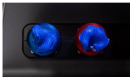
Un motif à rayures est projeté sur l'objet à scanner par le capteur 3D et enregistré par la caméra.
